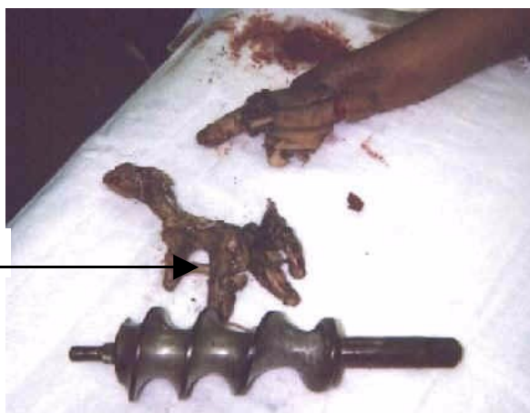
Exemplo de acidente de trabalho em rosca helicoidal.
