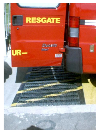
Posicionamento da viatura junto a grade de captação de resíduos da limpeza interna da viatura.
